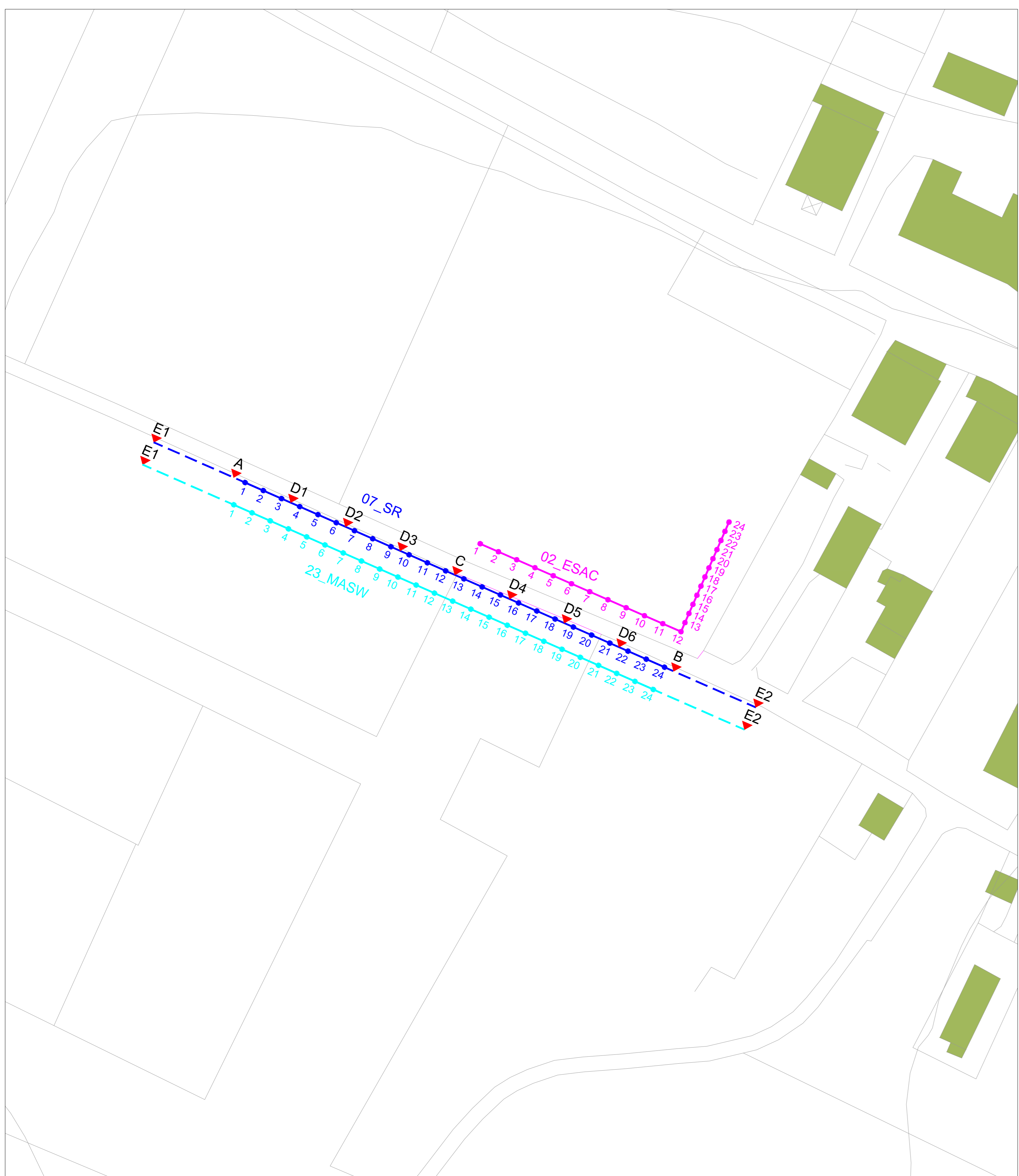
TUSSIO: PROVA SISMICA A RIFRAZIONE ONDE P 09_SR. ACQUISIZIONE 25_MASW. ARRAY SISMICO 04_ESAC - SCALA 1:500
